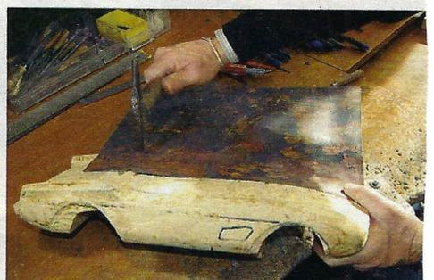
Mithilfe der Schablone wird das Karosserieblech sorgfältig zurechtgehämmert
